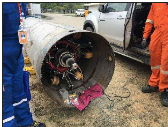
รูปที่ 2-48 การตรวจสอบการกักตัวของผิวภายในท่อด้วยการปล่อยกระสวย (Intelligent PIG)
