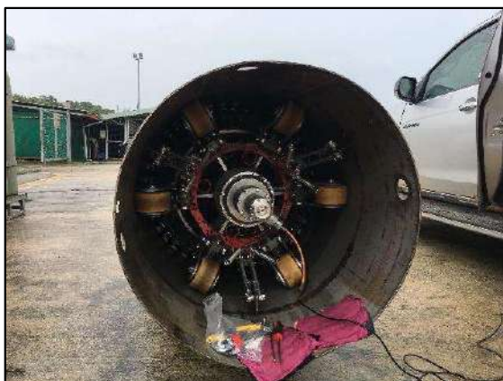
รูปที่ 2-48 การตรวจสอบการกักตัวของผิวภายในท่อด้วยการปล่อยกระสวย (Intelligent PIG)
