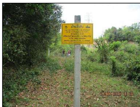
รูปที่ 2-35 การแจ้งเหตุที่แนวท่อส่งก๊าซ ต้องแสดงสัญลักษณ์ด้วยป้ายสีเหลืองที่สามารถสังเกตเห็นได้ชัดเจน
